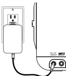
Per ricaricare e attivare la riproduzione dall'iPhone/iPod, inserire lo spinotto del cavo dell'adattatore CA nella presa a jack sulla parte posteriore dell'iH15 e la spina del suddetto adattatore in una presa di corrente
