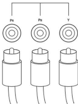
Per il segnale **Composite Video**, utilizzare solo il connettore a jack centrale
