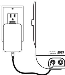
Beiliegendes Netzadapterkabel an den Anschluss auf der Rückseite des iH15 anschließen und das andere Ende in eine funktionierende Steckdose stecken um iPod abzuspielen und zu laden
