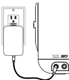
Conecta el adaptador de corriente al conector de la parte trasera del iH15 y, por el otro extremo, a un enchufe de corriente para reproducir y cargar el iPhone/iPod.
