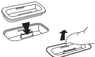
Scegliere l'adattatore per dock per il proprio modello di iPhone/iPod nella tabella sottostante e inserire l'adattatore nel dock. Per rimuovere l'adattatore, inserire l'unghia del pollice nella fessura e tirare delicatamente verso l'alto.
