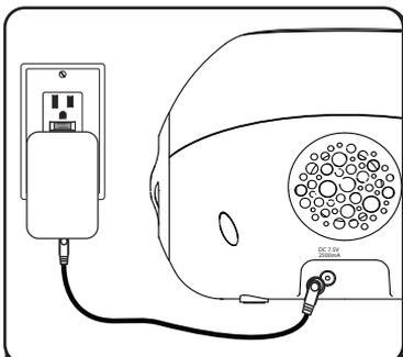
Per ricaricare e attivare la riproduzione dall'iPhone/iPod, inserire lo spinotto del cavo dell'alimentatore nella presa a jack sulla parte posteriore dell'iP15 e la spina del suddetto alimentatore in una presa di corrente.
