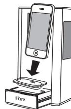
Den passenden Einsatz für Ihr iPhone/iPod aus der unteren Liste auswählen und in das Dock einsetzen. iPhone/iPod behutsam in das Dock einsetzen (iPhone/iPod darf sich dabei nicht in einer "Skin" oder Hülle befinden). iPhone /iPod wird aufgeladen, während es sich im Dock befindet. Play-Taste am iP39 drücken um iPhone/iPod abzuspielen.
