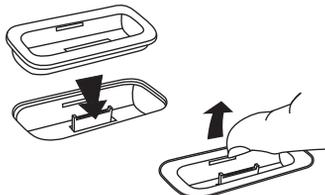
Sélectionnez l'insert correspondant à votre modèle d'iPhone/iPod dans la table ci-dessous et placez l'insert sur la station d'accueil. Pour retirer l'insert, placez votre ongle dans l'encoche et tirez doucement vers le haut.
