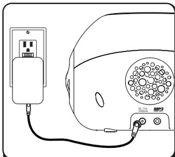
Branchez le câble de l'adaptateur secteur à l'arrière de l'iP15 et branchez l'autre extrémité dans une prise de courant pour écouter et charger l'iPhone/iPod.
