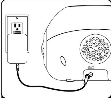
Conecta el adaptador de corriente al conector de la parte trasera del iP15 y, por el otro extremo, a un enchufe de corriente para cargar y reproducir el iPhone/iPod.
