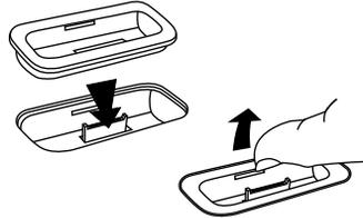
Selecciona la base adecuada para tu modelo de iPhone/iPod según la tabla siguiente y colócala en el acoplamiento. Para sacar la base, mete la uña en la ranura y estira hacia arriba con cuidado.
