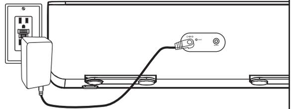
Netzadapter in den Netzeingang auf der Rückseite des iP56 einstecken und das andere Ende in eine funktionierende Steckdose stecken. Die interne Batterie (und das gedockte iPhone/iPod) werden aufgeladen.
