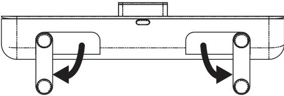
Standfüße auf der Unterseite des iP56 ausklappen, dann das Gerät zum Betrieb richtig herum drehen.
