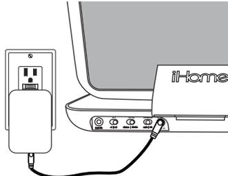
Per attivare la riproduzione e la ricarica della batteria dell'iPhone/iPod e per ricaricare la batteria interna, inserire lo spinotto del cavo dell'adattatore CA nella presa a jack CC sulla parte posteriore dell'iP49 e la spina del suddetto adattatore in una presa di corrente.
