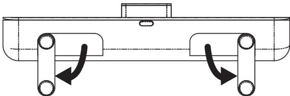
Saca el pie de apoyo de la base de la unidad iP56 y, a continuación, coloca la unidad derecha para su funcionamiento.
