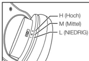
Der Lautstärkeschalter befindet sich auf der Innenseite der linken Hörmuschel. Stellen Sie den Schalter der Kopfhörerlautstärke als Erwachsener mit einer Büroklammer, einem spitzen Bleistift oder einem kleinen Werkzeug auf H (hoch), M (mittel) oder L (niedrig).
