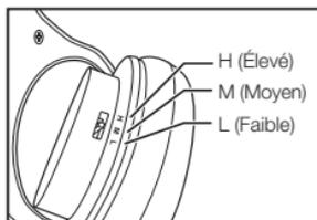
Le commutateur de volume est situé à l'intérieur de l'oreillette gauche. Avant d'utiliser votre casque, demandez à un adulte de positionner le commutateur de volume sur un niveau approprié (Élevé, Moyen ou Faible) en se servant de la pointe d'un stylo, d'un trombone ou autre objet similaire.
