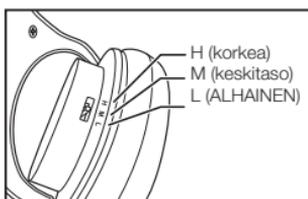
Äänenvoimakkuuden säädin sijaitsee vasemman korvakupin sisäpuolella. Anna ennen käyttöä aikuisen asettaa kuulokkeiden äänenvoimakkuus korkeaan, keskitasoon tai alhaiseen kynällä, paperiliittimellä tai muulla pienellä esineellä.
