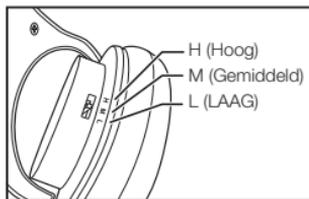
De volumeregelaar bevindt zich aan de binnenkant van de linker oorschelp. Laat voor gebruik een volwassene de schakelaar verschuiven door middel van een potlood, paperclip of ander klein hulpmiddel om het volume van de hoofdtelefoon in te stellen op Hoog, Gemiddeld of Laag.
